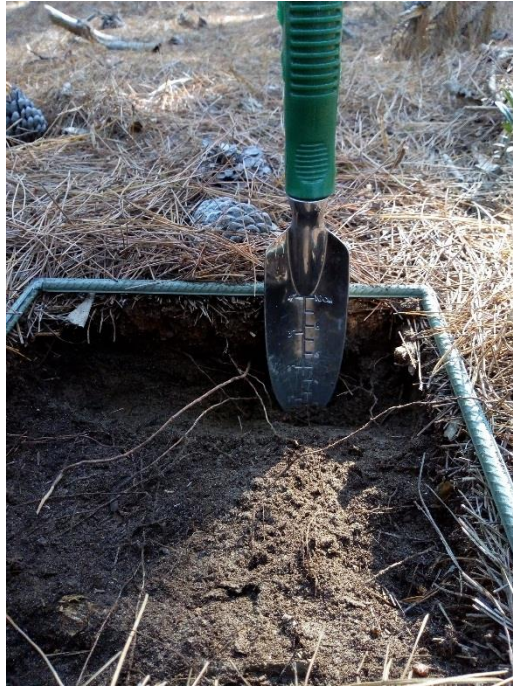
Figura 5. Marcos de hierro utilizados para la toma de muestra de horizontes orgánicos en el tratamiento bosque (TB).
