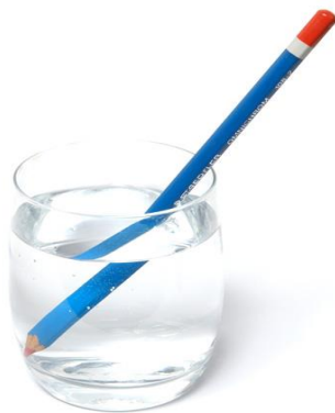
Figura 2-3 La diferencia en los índices de refracción del agua y el aire produce el cambio de dirección de la luz cuando ésta se propaga de un medio a otro.
