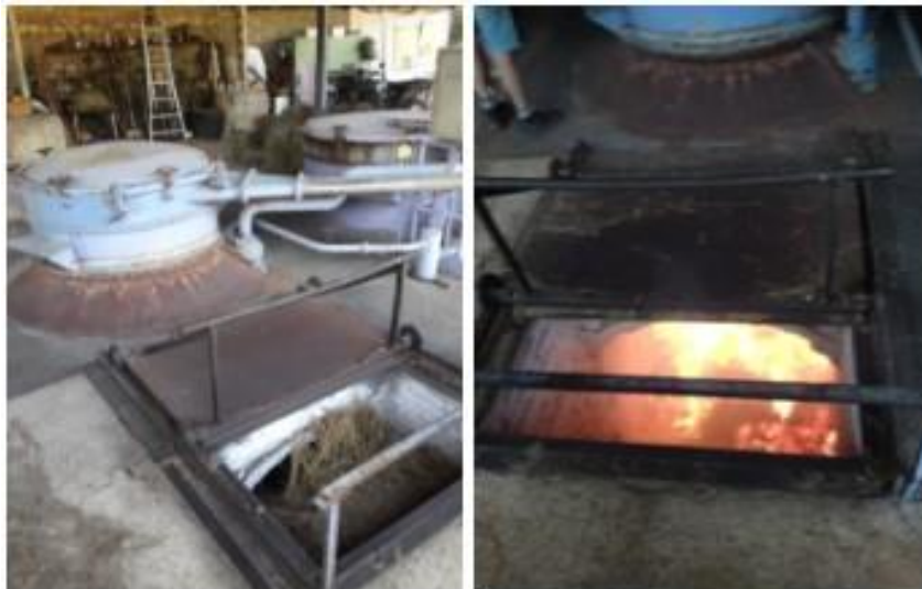
Figura 17. La paja seca de las lavandas que queda como remanente de la destilación se coloca en el horno y se utiliza como combustible para calentar el agua en la Destilería Blanc en Teyssières. Fotos propias.
