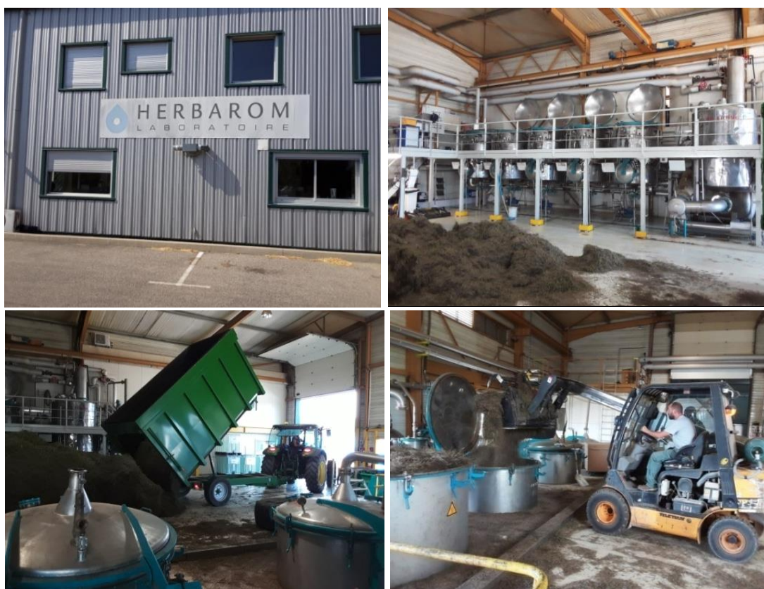
Figura 18. Destilería Herbarom Laboratoire en la localidad de Aouste-sur-Sye. A: Frente del edificio. B-D: Proceso de descarga de la tolva y llenado de los tanques de destilación. Fotos propias.
