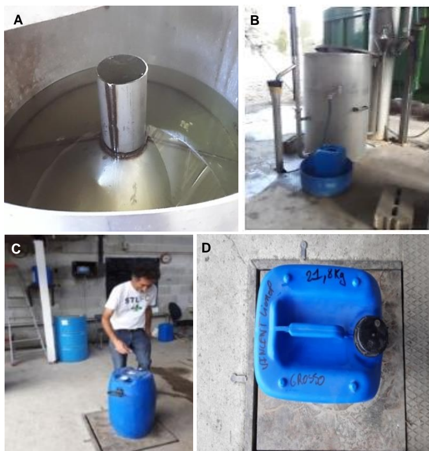
Figura 14. Destilación del aceite de lavanda. A: Al llegar al reservorio, el aceite sube por el tubo interior por diferencia de densidad, separándose así de la fase acuosa. B: Llenado de bidones con aceite esencial. C: Pesaje de bidones en la misma destilería. D: Sobre el bidón se escribe el nombre del productor, el peso del aceite y la variedad de lavanda o lavandín que corresponde. Fotos propias.
