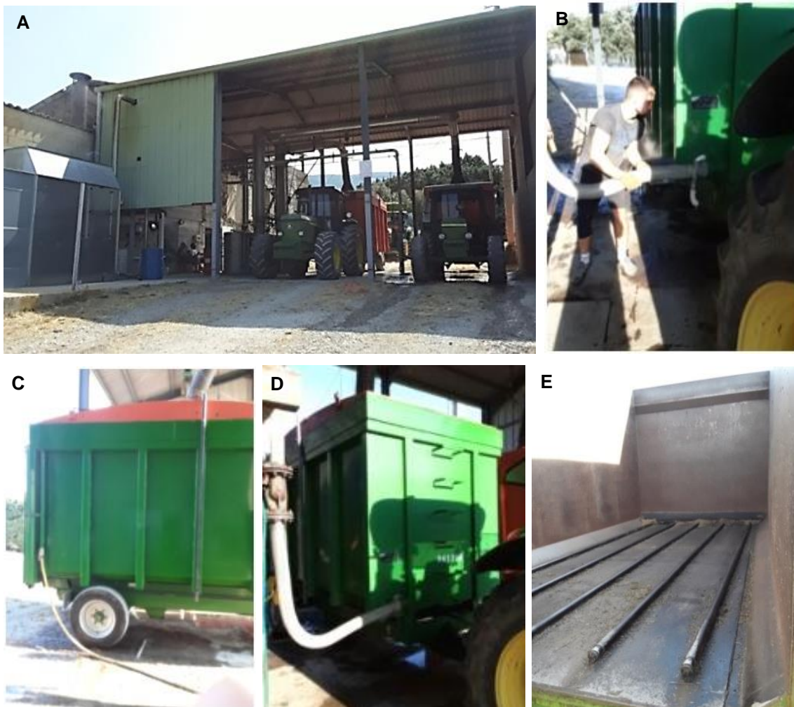
Figura 13. Etapas de destilación de lavanda en la Destilería CUMA, en Valréas. A: Dos tractores con sus respectivas tolvas en proceso. B: Operario colocando el caño de vapor en la tolva. C: Tapa naranja con caño de retorno (arriba) y caño amarillo de refrigeración (abajo a la izquierda). D-E: Caño de vapor que se conecta con el sistema de cañerías microperforadas ubicadas en la base de la tolva. Fotos propias.
