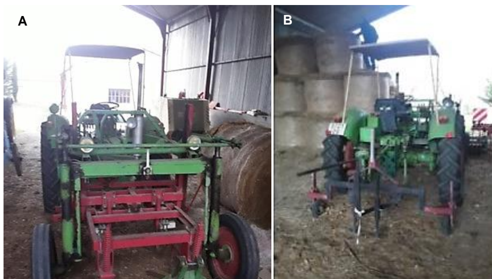
Figura 7. Desmalezadora mecánica de fabricación artesanal del Sr. Lionel Vincent. A: vista del implemento en la parte delantera del tractor; B: Vista de las rejas móviles enganchadas a la parte trasera del tractor. Fotos propias.
