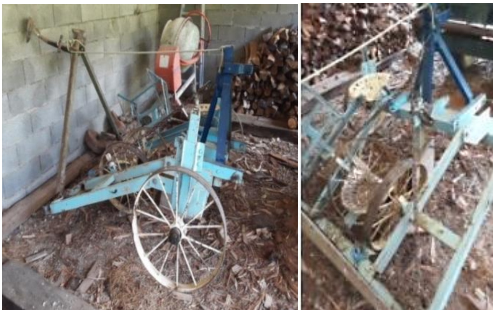
Figura 6. Sembradora de lavandas de fabricación artesanal del productor Sr. Lionel Vincent. Fotos propias.
