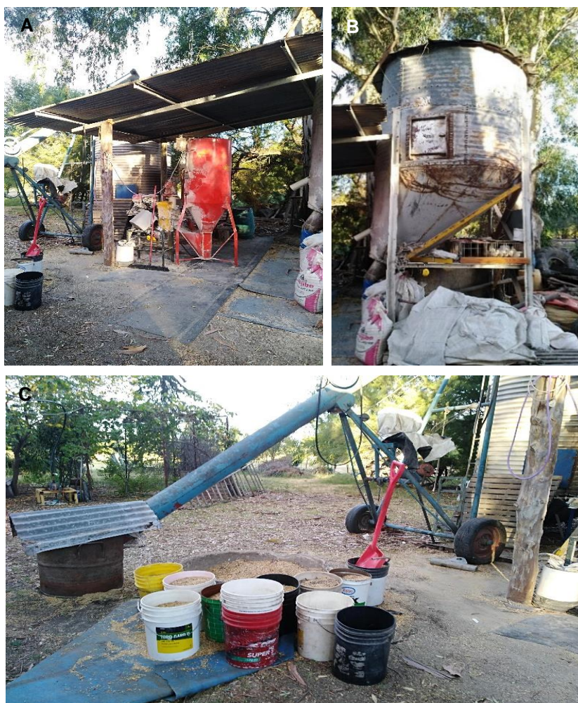
Figura 22: Instalaciones existentes en el establecimiento del productor A. A: mezcladora; B: silo; C: elaboración de la dieta a partir del cereal que le entregan en el puerto. Fotos propias.
