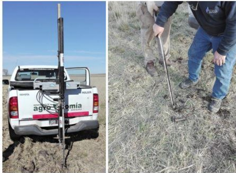
Figura 6: Muestreador de suelos automatizado y recolección de muestras de suelo.
