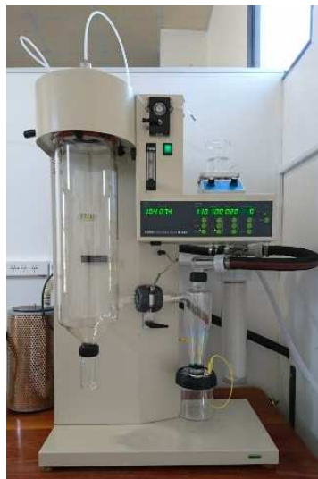
Figura 2.8: Mini Spray Dryer Büchi B – 290.
