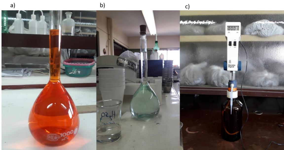
Figura 11. a) Preparación del  $K_2Cr_2O_7$  b) Preparación de la sal de Mohr. c) Bureta electrónica utilizada para titulación.
