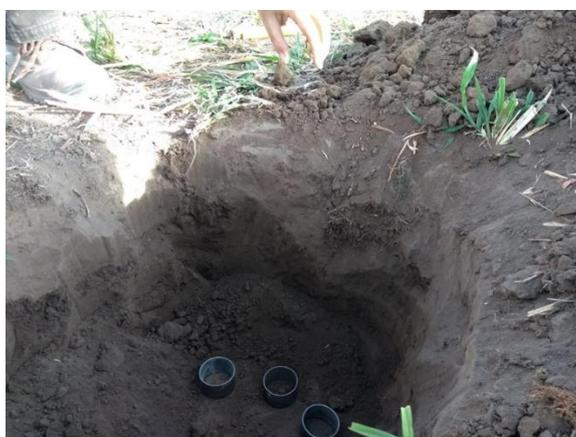
Figura 4. Cilindros utilizados en la medición de densidad aparente.
