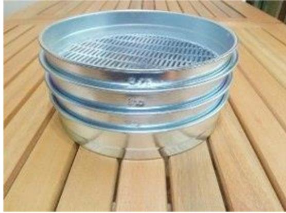
Figura 7: Tamices ensamblados para determinación de calibre
