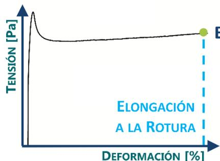
FIGURA 4. 6 REPRESENTACIÓN GRÁFICA DE LA MEDICIÓN DE LA ELONGACIÓN A LA ROTURA DE UN MATERIAL POLIMÉRICO EN UNA CURVA DE TENSIÓN-DEFORMACIÓN.
