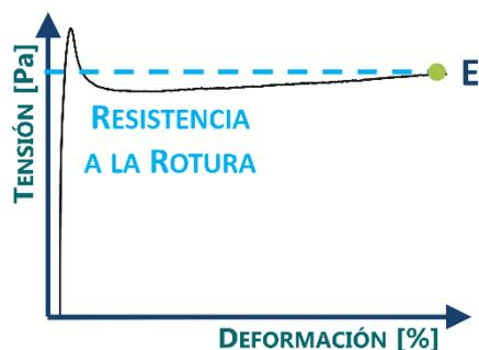
**FIGURA 4. 7** REPRESENTACIÓN GRÁFICA DE LA MEDICIÓN DE LA RESISTENCIA A LA ROTURA DE UN MATERIAL POLIMÉRICO EN UNA CURVA DE TENSIÓN-DEFORMACIÓN.
