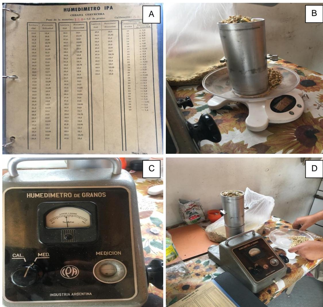
**Figura 30:** Elementos utilizados para medir la humedad en la muestra de cebada. **A:** Tabla de conversión del equipo. **B:** Balanza digital. **C-D:** Humedímetro portátil.
