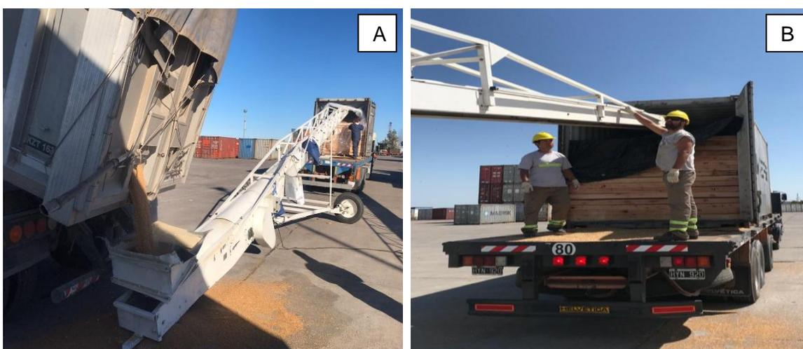
**Figura 13:** Operatoria de carga de los contenedores. A: Cintas transportadora de granos; B. Camión de circulación interna.
