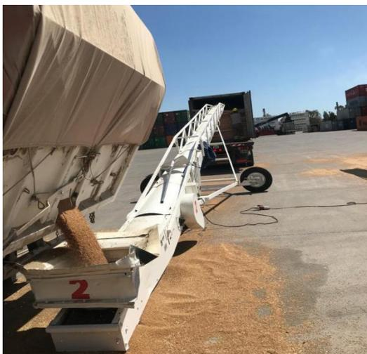
Figura 36: Cargando trigo en una línea de carga.
