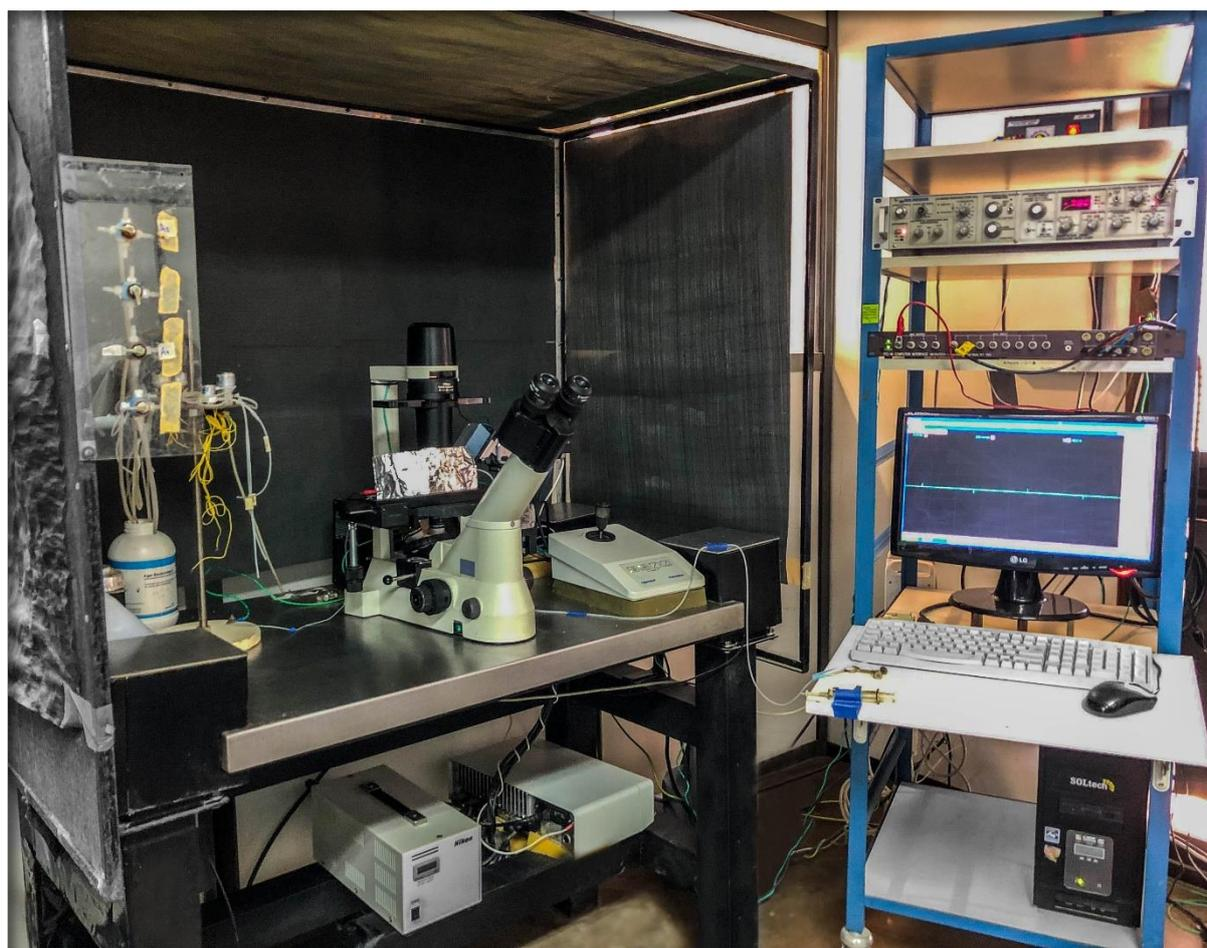
**Figura 13** Set up para la obtención de registros de *patch clamp* utilizada en esta tesis.
