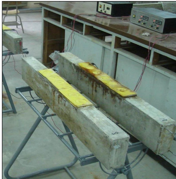
Figura 6.7: Ensayo de corrosión acelerada efectuado sobre las vigas.
