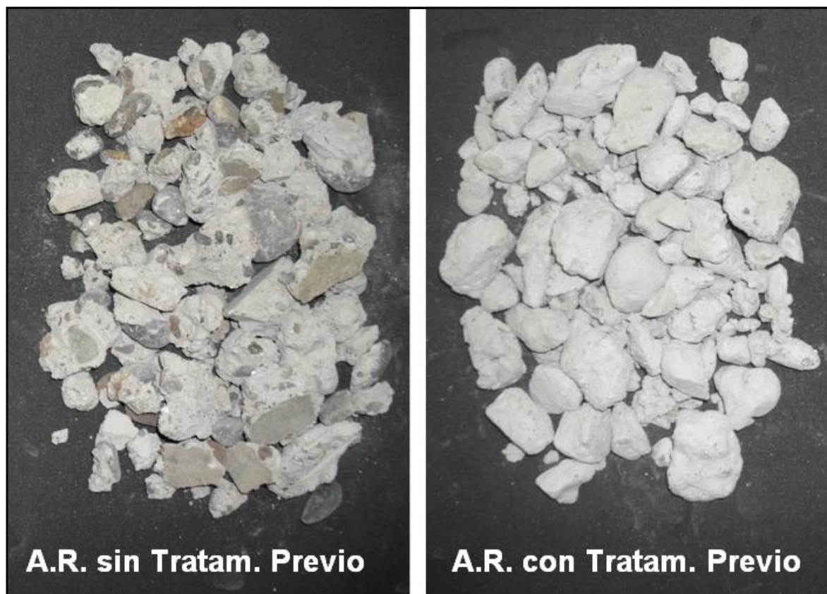
Figura 5.2: Vistas del agregado de hormigón reciclado antes y después del tratamiento previo
