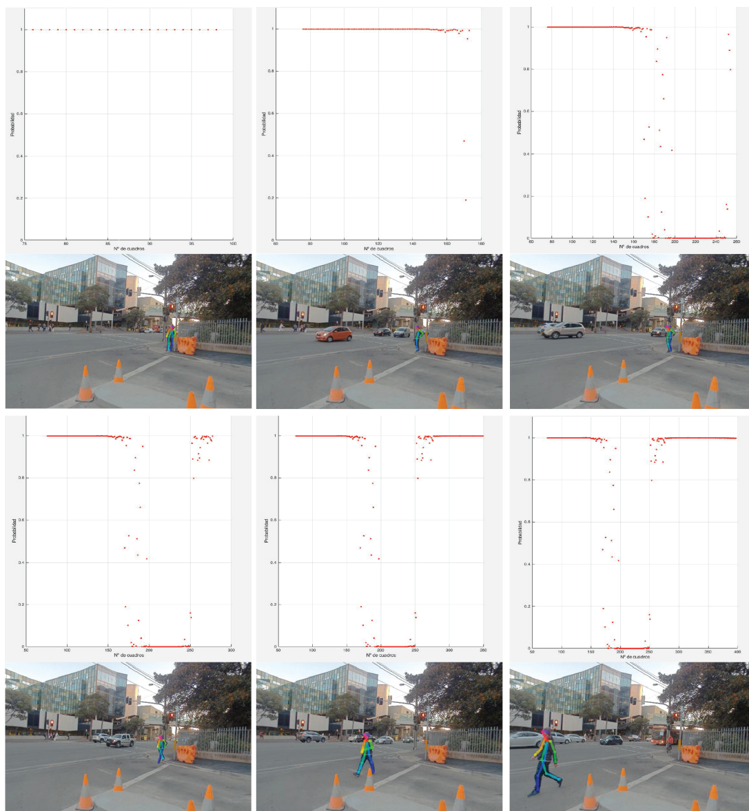
Figura 5.9: Secuencia de uno de los ejemplos más relevantes. En la fila superior se muestra el gráfico de la probabilidad y en la inferior la imagen de video correspondiente a tal, para 6 instantes de tiempo diferentes.
