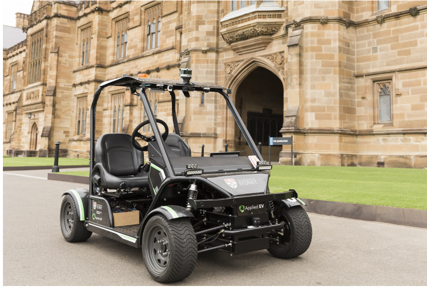
Figura 4.3: Vehículo eléctrico autónomo modernizado con tecnología de visión perceptiva.
