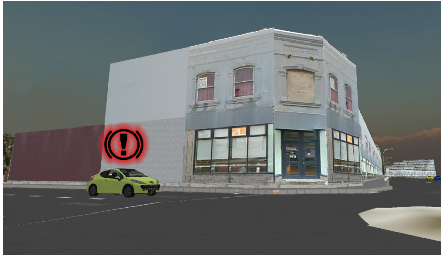
Figura 2.7: Símbolo sobre el vehículo para indicar algún tipo de peligro. Este tipo de advertencias son el resultado de algoritmos de prevención evaluados en el simulador.
