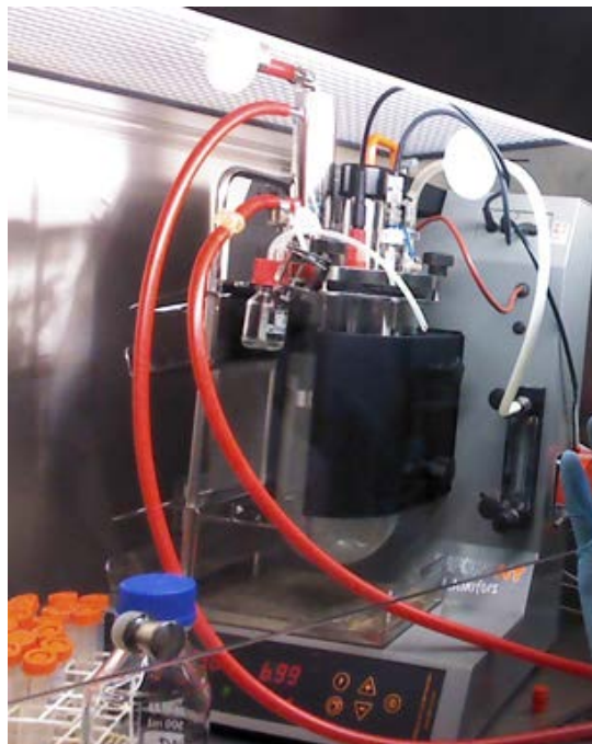
Figura 2.3. Biorreactor Multifors de 2,5 L.
