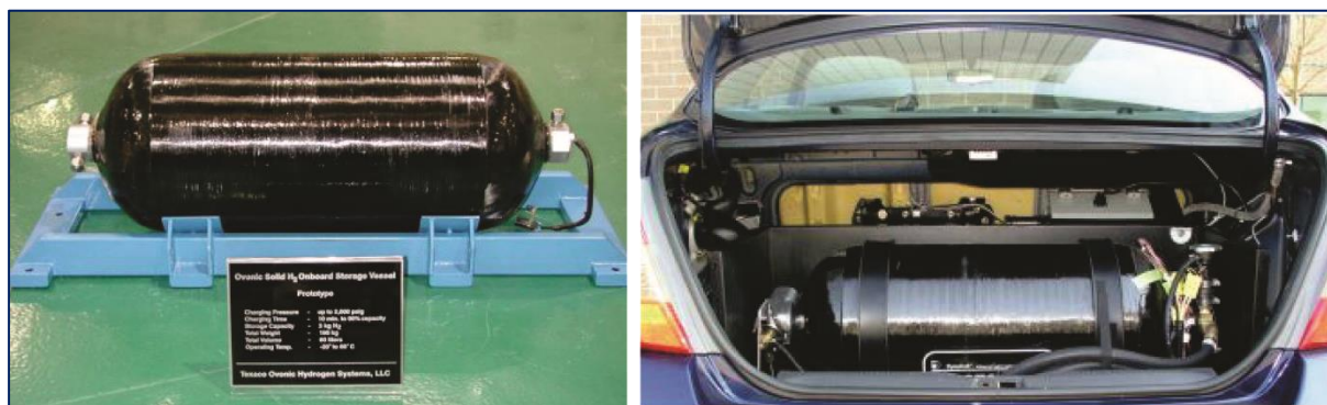
Figura 1.23.- Prototipo a bordo de batería de hidruro metálico Ovonic 75 .
