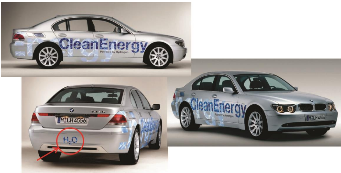
Fig. 2.7- BMW 7. Modelo limitado de vehículo que emplea hidrógeno líquido como combustible.
