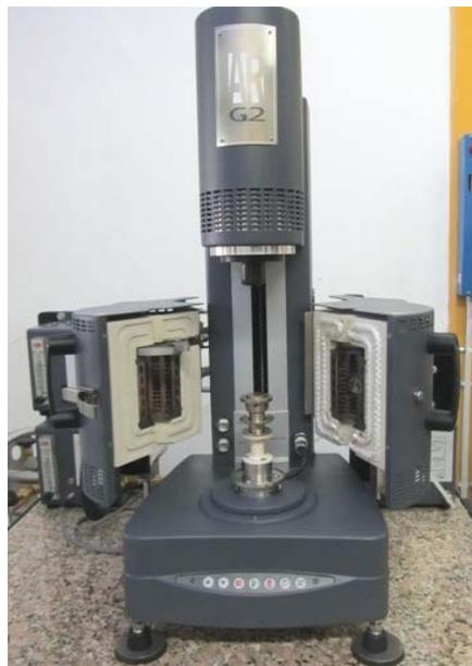
**Figura 3.13.** Vista parcial del reómetro rotacional *AR-G2* con cámara de calefacción y geometría de platos paralelos
