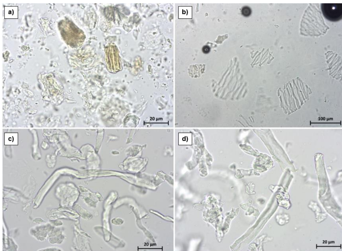
Figura 2.14. Micrográficas de los geles adicionados con distintas variedades de fibra dietaria, a) M, b) P, c) B y d) T.
