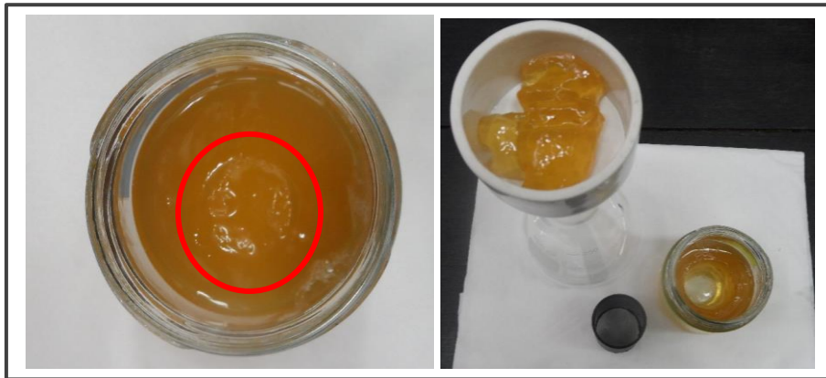
Figura 3.5. Porción de muestra tomada para la determinación de la sinéresis. La zona delimitada con una línea roja corresponde a la zona penetrada por la sonda durante el test de penetración.
