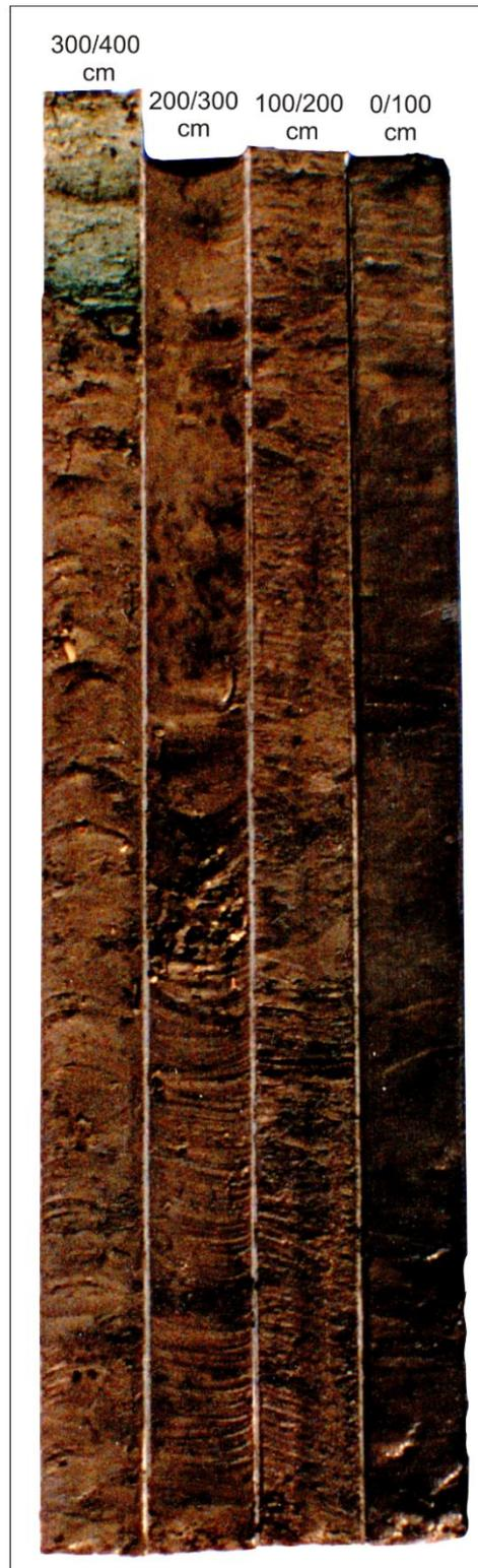
*Figura 11. Fotografía del Testigo KP60BIS, antes de realizar el muestreo.*
