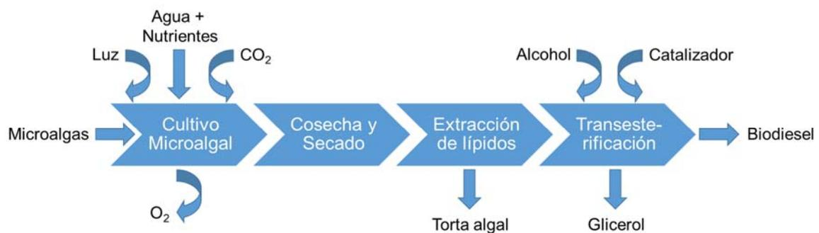
**Figura 2.1.** Etapas del proceso de producción de biodiesel a partir de microalgas. Fuente: Arias Peñaranda *et al.* (2013)
