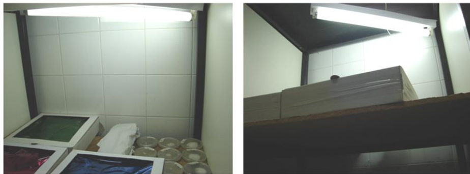
Figura 34. Cuarto de cultivo e irradiación de luz. En la figura de la izquierda se muestra la disposición de los tratamientos, y en la de la derecha la ubicación del tubo fluorescente.
