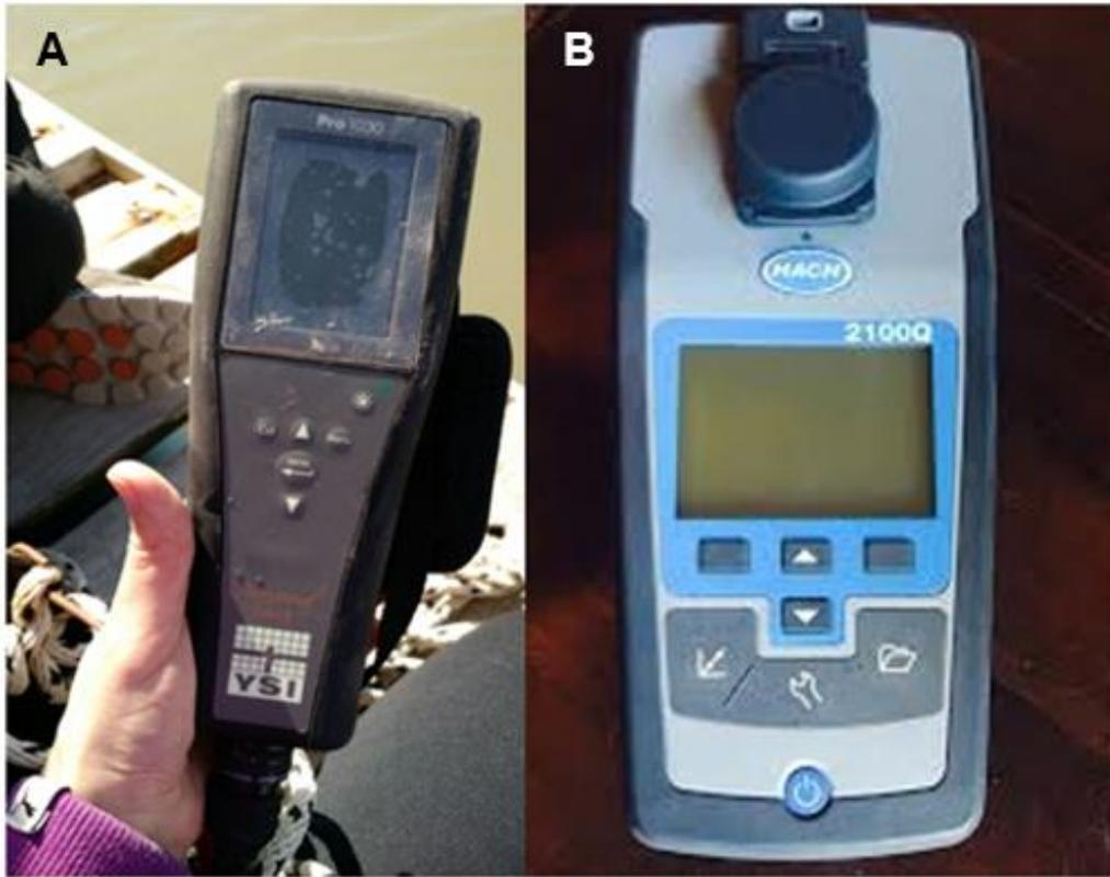
**Figura 6.** A. Sonda multiparamétrica YSI Pro 1030, B. turbidímetro portátil Hach 2100Q IS.
