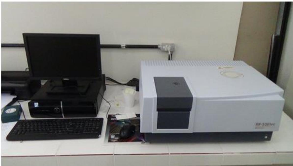
**Figura 8.** Espectro fluorómetro Shimadzu RF 5301 PC.
