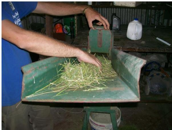
Figura 7. Maquina picadora utilizada para confección de ensilajes.
