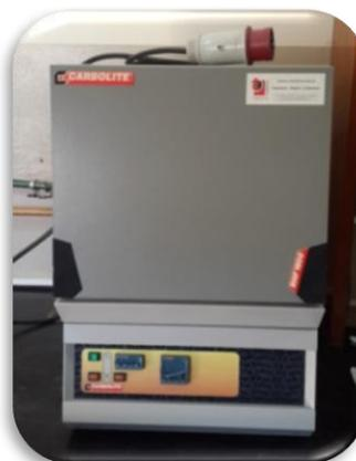
**Fig.3.3.2: Mufla donde se realizó la síntesis**
