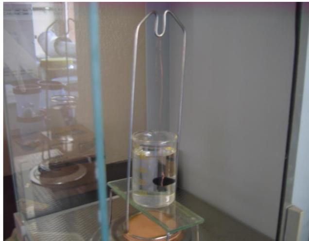
**Fig.4.3.1.1: balanza analítica donde se determinaron las densidades**
