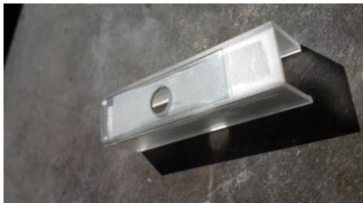
**Fig.4.4.3: Cubeta utilizada en el Espectrómetro UV-Visible**
