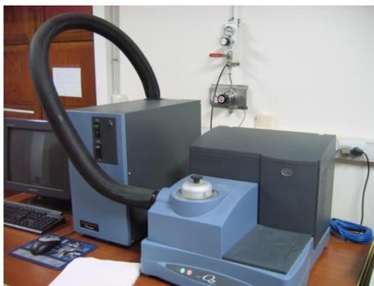
**Fig.4.2.2.3.1: Calorímetro diferencial de barrido (DSC Q20 adosado a un DSC refrigerated cooling system)**
