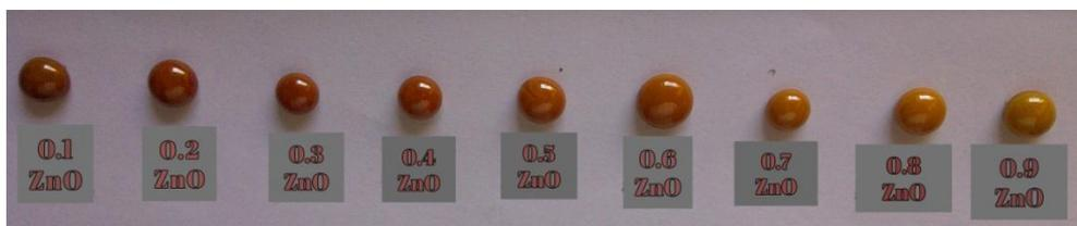
Fig.3.4.1: Muestra de ZnO-Li<sub>2</sub>O de todas las composiciones en forma de gotas
