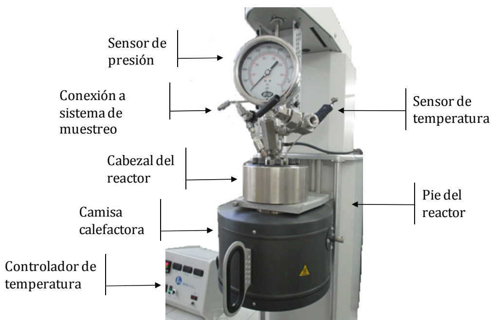
Figura 5.2: Reactor Parr utilizado para medición de datos de equilibrio.
