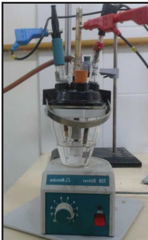
Figura 2.2. Fotografía de la celda Metrohm.
