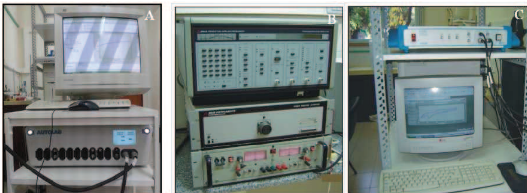
Figura 2.4. Fotografías del equipamiento electroquímico utilizado: (A) Potenciostato-Galvanostato Autolab/PSTAT128N, (B) Potenciostato-Galvanostato PAR modelo 273 A y (C) Voltalab 40 Potentiostat PGZ30.
