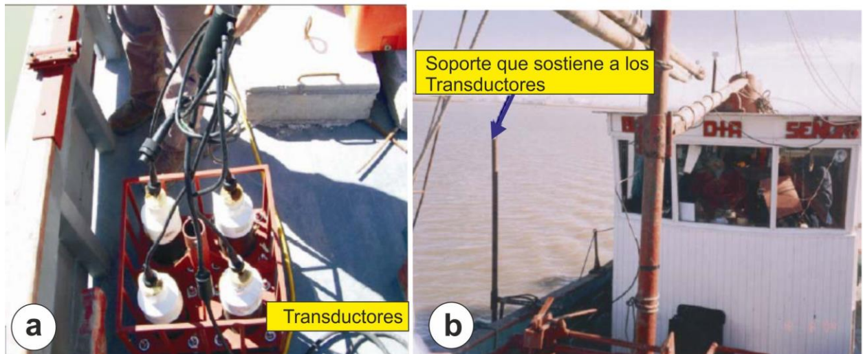
Figura 2.4. a. Transductores del Perfilador 3,5 kHz; b. Fotografía de la estructura soporte de los transductores colocado a estribor de la embarcación.
