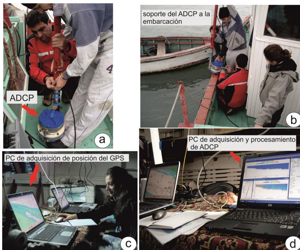
Figura 2.5. a. ADCP Workhorse Broadband Monitor 600kHz de RDI Instrument; b. Maniobra de instalación del ADCP; c. PC para recopilación y control de datos de navegación; d. PC para adquisición y procesamiento de los datos de corrientes.
