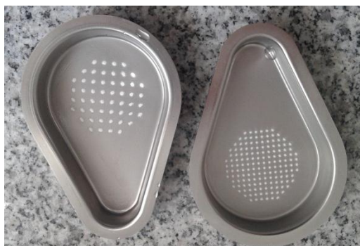
Figura 5.2. Fotografía de las muestras de (AA-AT)_{75}:K 2\% c colectadas en las etapas de separación 3 y 4 del equipo NGI (que, para una caída de presión de 4 KPa, presentan diámetros de corte de 2,85 y 1,68 \mu m , respectivamente)
