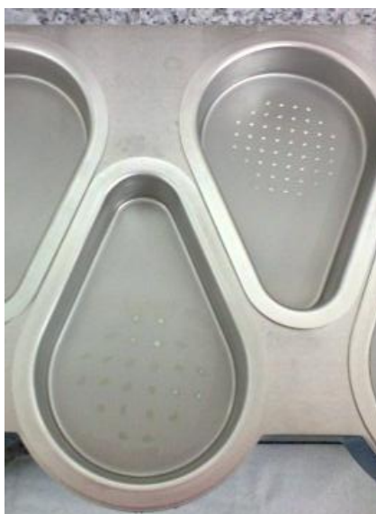
Figura 6.2. Micropartículas PL-IN depositadas en las etapas 3 y 4 del equipo NGI (que, para una caída de presión de 4 KPa, presentan diámetros de corte de 2,85 y 1,68\ \mu\text{m} , respectivamente)
