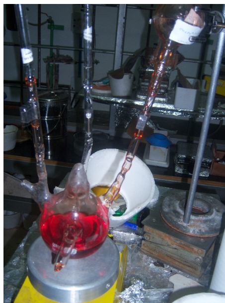
Figura 4.10 Fotografía del reactor con el complejo formado por el PS-Li + y DFE.
