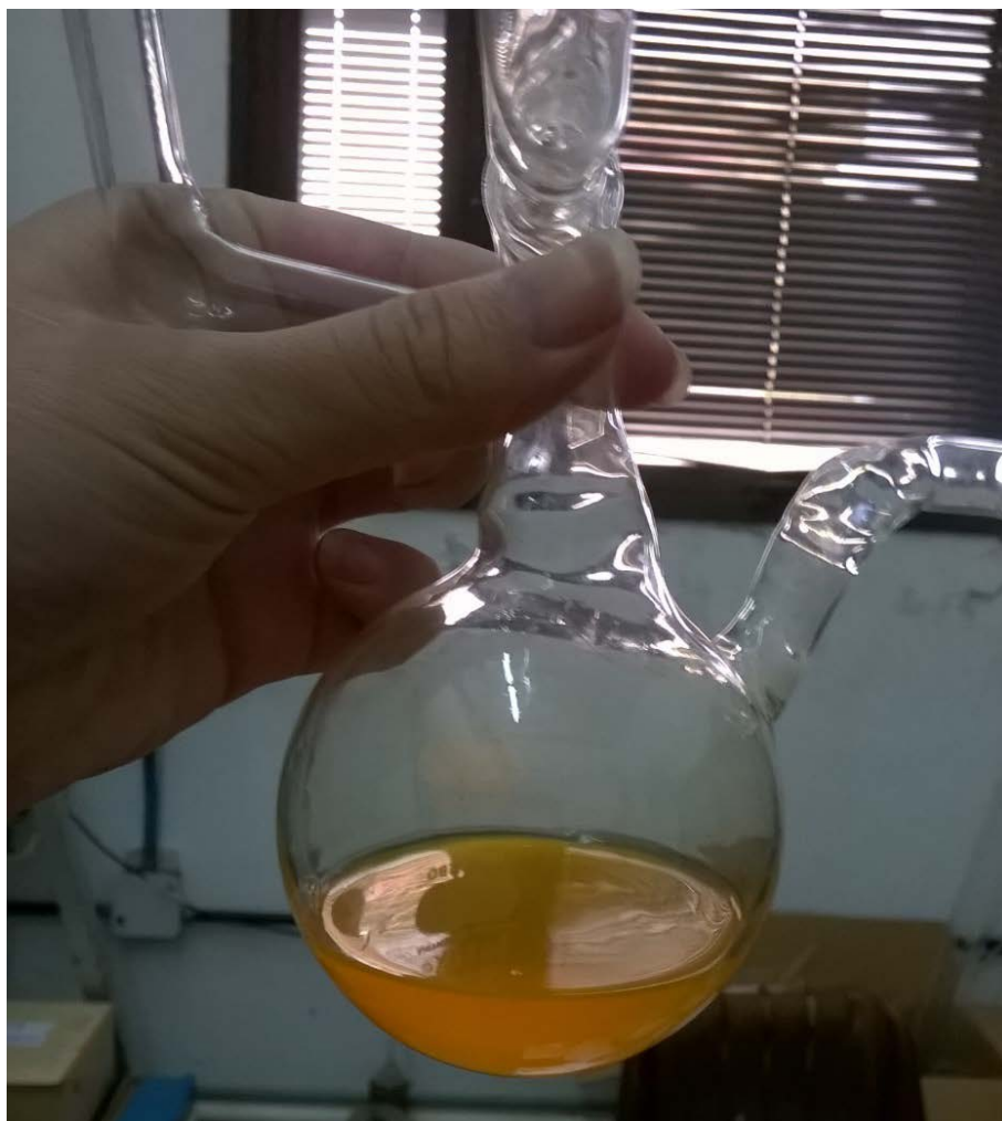
Figura 4.6. Fotografía del primer bloque del copolímero, \text{PS}\cdot\text{Li}^+ en ciclohexano, (E1).
