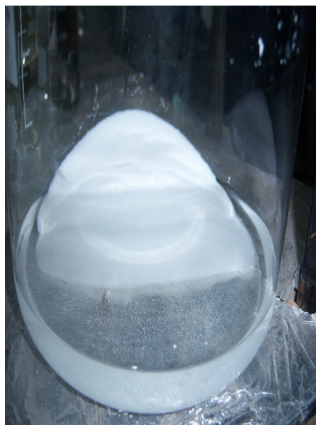
Figura 4.12 Fotografía del copolímero PS- b -PMMA precipitado en un exceso de metanol helado.
