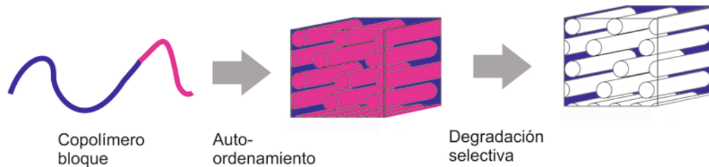
Figura 2.7 Esquema del procedimiento de fabricación de membranas nanoporosas.
