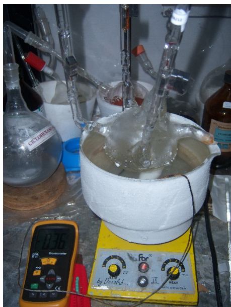
Figura 4.11 Fotografía de la reacción de polimerización del bloque de MMA a baja temperatura en un baño de N 2 líquido e Isopropanol.
