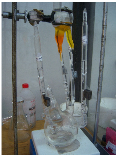
Figura 4.9 Fotografía del reactor de polimerización del bloque de PMMA, separado de la purga.
