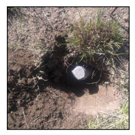
**Figura 8.1** Vista superior de los tubos PVC (15 cm longitud, 3,5 cm diámetro), puestos a incubar *in situ*.
