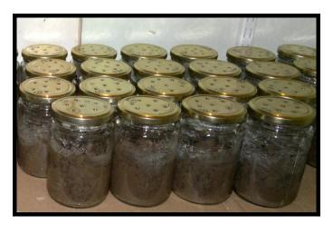
**Figura 8.2**. Frascos conteniendo 250 g de suelo para determinación de mineralización neta potencial de N por incubación aeróbica.
