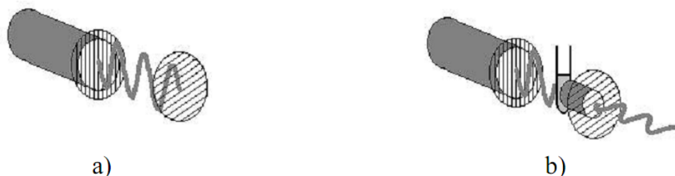
Figura 7.2 Efecto de las fases anisotrópicas en la luz polarizada. A) polarizadores cruzados, sin muestra. No se transmite la luz. El mismo efecto se obtiene cuando se inserta una muestra isotrópica entre los polarizadores b) polarizadores cruzados, muestra anisotrópica. La luz es transmitida.
