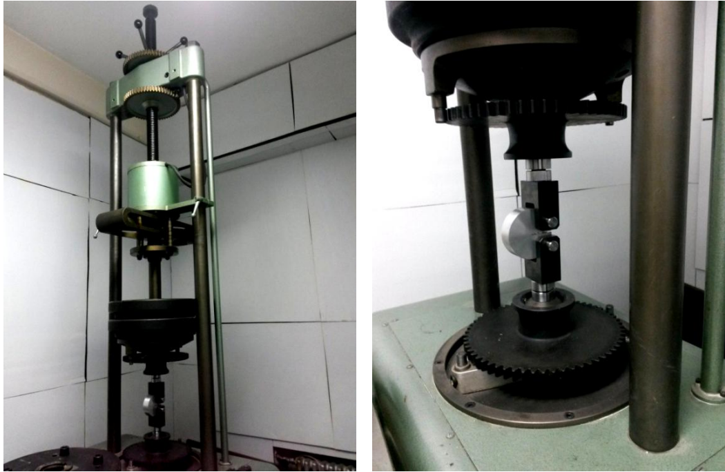
Figura 4.17: Vibróforo de alta frecuencia AMSLER, modelo Type 10 HFP 422. Detalle de equipo operando (der.).
