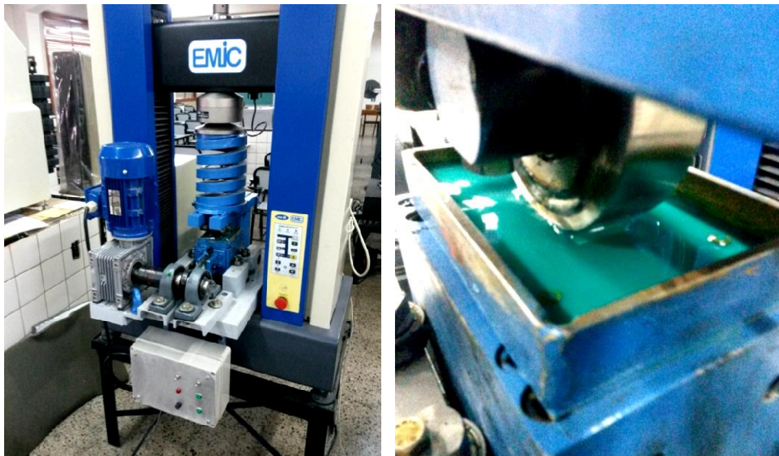
Figura 5.11: Tribómetro de rodadura de contacto lineal. Detalle de la rueda sobre la probeta sumergida en lubricante (der.).
