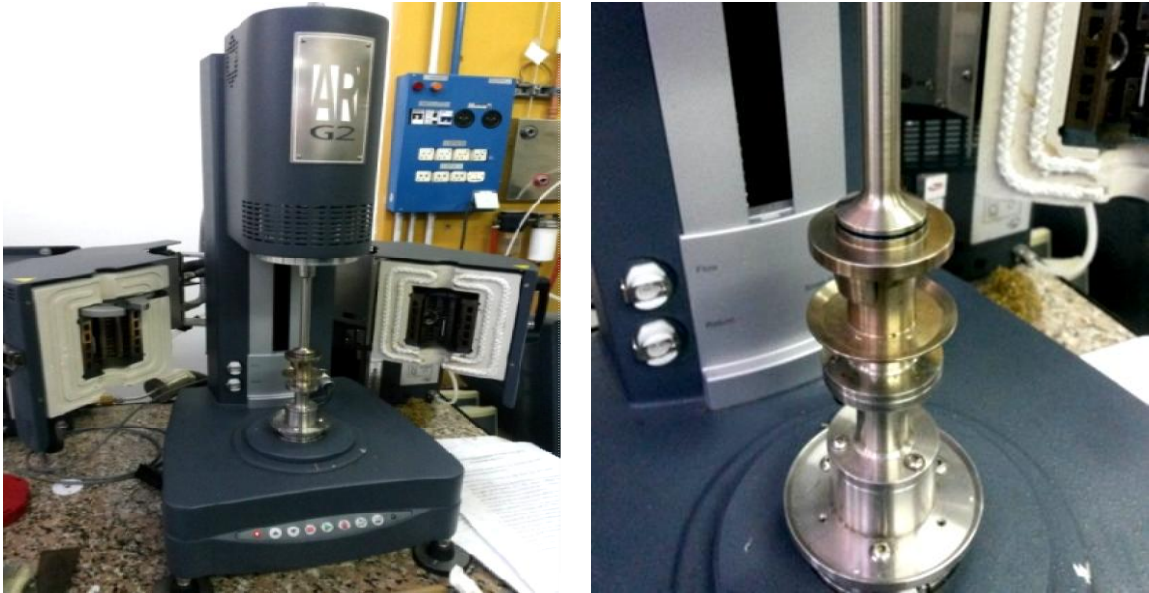
Figura 4.15: Reómetro AR-G2 de TA Instruments. Detalle de la geometría de medición con una muestra de lubricante (der.).
