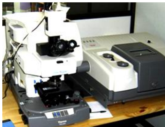
Figura 4.14: Espectrómetro de infrarrojo Nexus 520 con microscopio acoplado.
