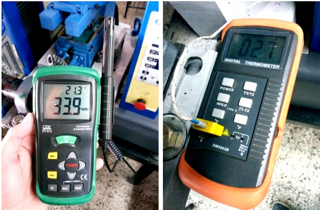
Figura 4.20: Equipo para la medición de temperatura y humedad del ambiente (izq.), y equipo para monitoreo de temperatura en diferentes puntos del ensayo (der.).
