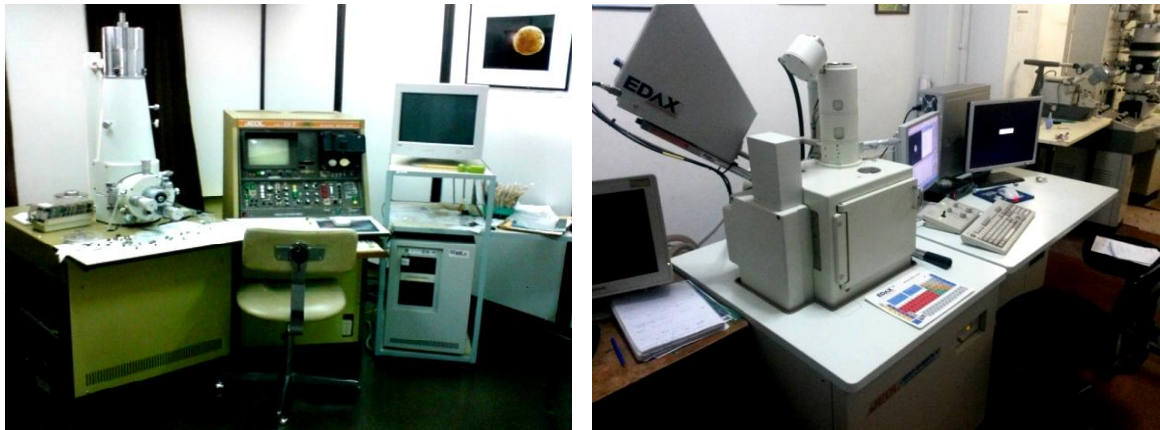
Figura 4.8: Microscopios electrónicos de barrido con detector de electrones secundarios. Jeol 35CF (izq.) y Jeol JSM-6460LV(der.).
