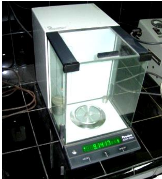
Figura 4.3: Balanza de precisión utilizada para la preparación de mezclas lubricantes.
