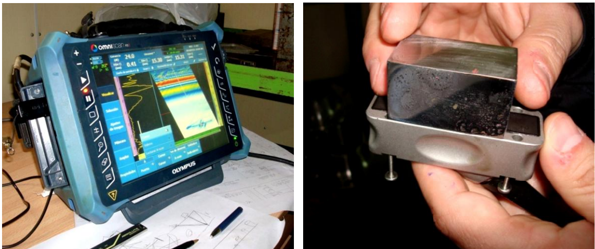
Figura 4.19: Equipo de ultrasonido Olympus Omniscan. Detalle del detector 5L60 sobre una probeta pre-fisurada de contacto lineal (der.).
