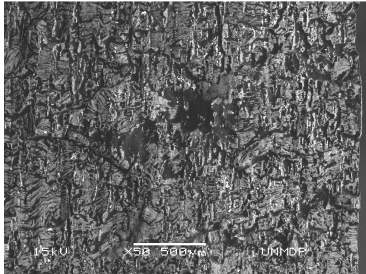
Figura 9.37: Morfología de la superficies de fisura pertenecientes al ensayo AL-75%GL-1000-N01. Fluido lubricante: 75% glicerina/25% agua (Mag.: 50x).
