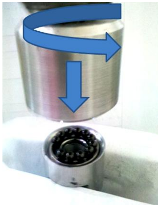
Figura 6.12: Rodamiento montado en el tribómetro de contacto puntual.
