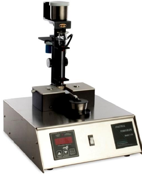
Figura 4.16: Ferrógrafo para el análisis de las partículas de desgaste.
