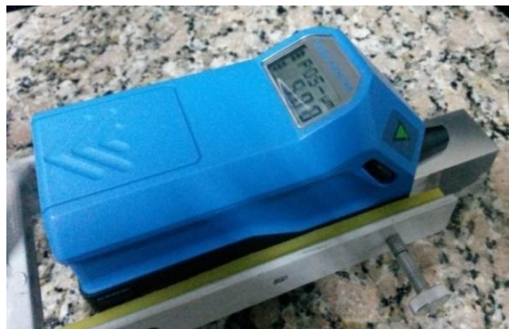
Figura 4.10: Rugosímetro Jenoptik realizando una medición sobre una probeta de contacto lineal.
