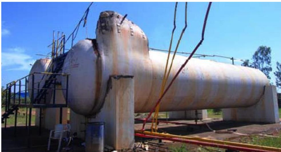
**Figura 3.5 Fallo de recipiente a presión durante prueba hidraulica en inspección anual**
