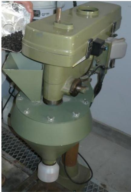
**Figura 3.** Vista general del equipo piloto utilizado para el descascarado mecánico (de Figueiredo *et al.*, 2014).
