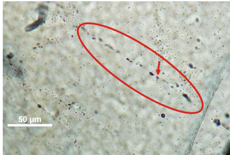
Figura 2.8: Inclusiones fluidas dentro de los cristales de cuarzo que forman parte de las cintas, dispuestas en forma alineada en dirección perpendicular a la foliación milonítica, en roca granítica con textura stripped gneiss (dentro del óvalo color rojo), en su mayoría monofásicas. Con flecha roja se señala una inclusión bifásica.
