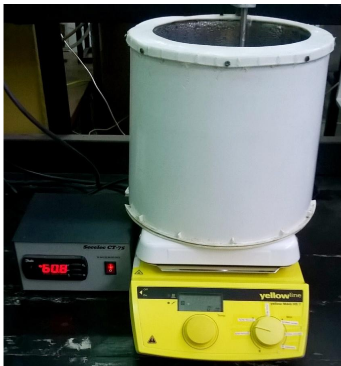
Figura 2.3. Equipo experimental. Baño termostático con controlador de temperatura y agitador magnético.
