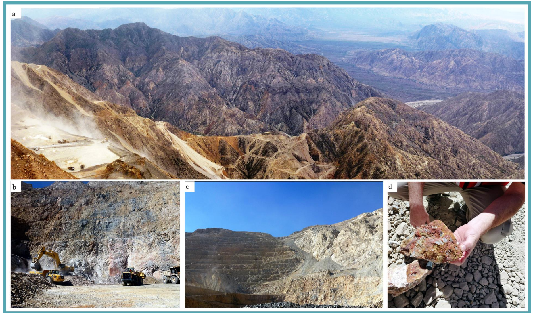
Figura 6.5. Quebrada del Diablo Main. a) Vista panorámica de parte del open pit de Quebrada del Diablo Main. b) Interior mina donde se observan los bancos de explotación y las maquinarias con las que se carga la roca extraída. c) Vista de los bancos de explotación. d) Detalle de la brecha mineralizada característica de Quebrada del Diablo Main.
