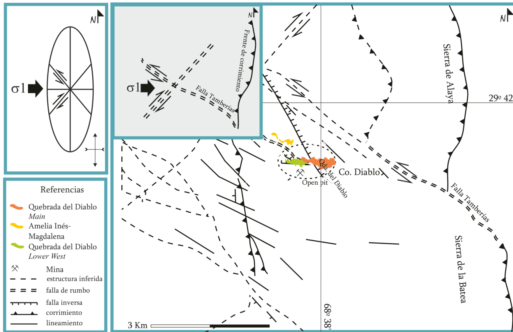
Figura 7.12. Mapa de estructuras y esquema estructural mostrando la orientación de \sigma_1 , durante el desarrollo de la estructura en el Mioceno
