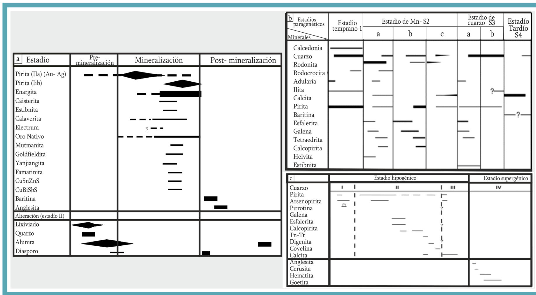
Figura 10.5. Diagramas paragenéticos de los depósitos mencionados en la tabla 10.1. a) Secuencia paragenética de los halos, venillas y cuerpos diseminados de alunita- pirita-enargita del depósito epitermal de alta sulfuración Pascua Au-Ag-Cu (Tomado de Chouinard et al. 2005). b) Estadios paragenéticos (S1, S2, S3, S4) y subestadios (a, b, c) identificados en el depósito Caylloma de sulfuración intermedia, Perú (Tomado de Echavarría et al. 2006) c) Diagrama paragenético del epitermal de baja sulfuración, distrito aurífero la Carolina, San Luis, Argentina (Tomado de Gallard-esquivel et al. 2012).
