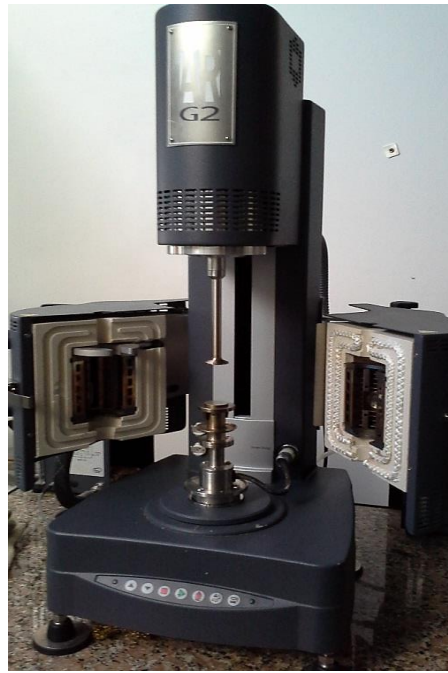
Figura 4.10 Reómetro rotacional AR-G2 con cámara de calefacción y geometría de platos paralelos
