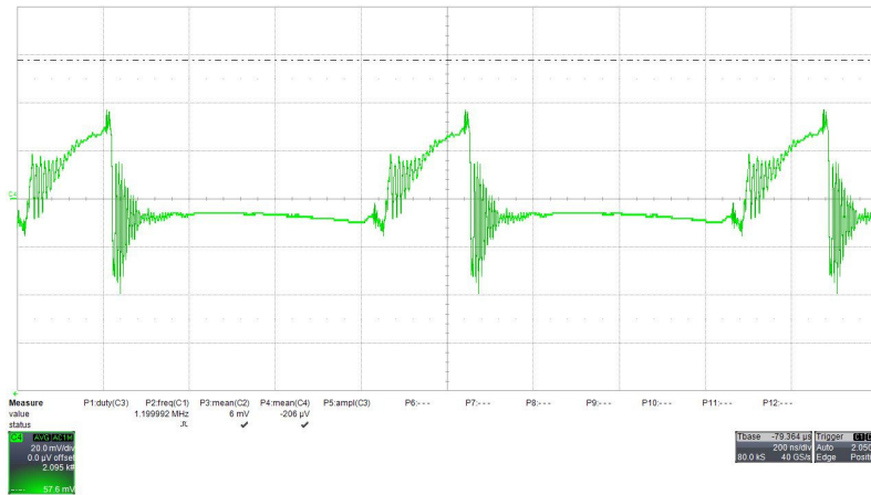
(a) Tensión deripple a la salida del convertidor con el filtro LC de 2 do orden. El ripple es de 76 mV.
