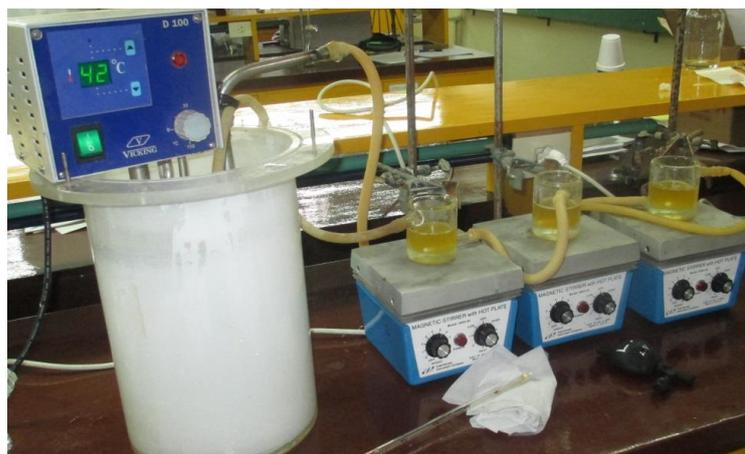
**Figura 2.2-** Sistema de tres reactores “batch” en paralelo.
