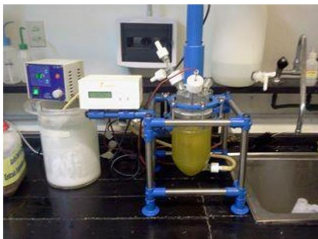
**Figura 2.3-** Reactor Batch de 1000 mL usado en los ensayos de desgomado enzimático en condiciones optimizadas.
