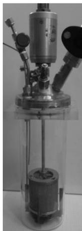
**Figura IV.18.** Reactor tipo Carberry utilizado en los ensayos con catalizador comercial.
