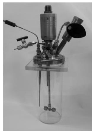
**Figura I.6.** Reactor con agitador monolítico (MSR) escala laboratorio.
