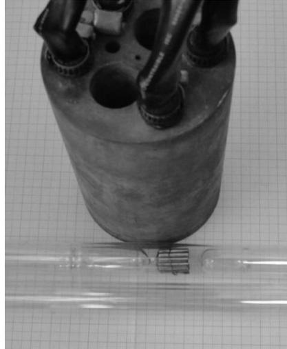
**Figura II.6.** Detalle del horno y los tubos de referencia y portamuestra utilizados.
