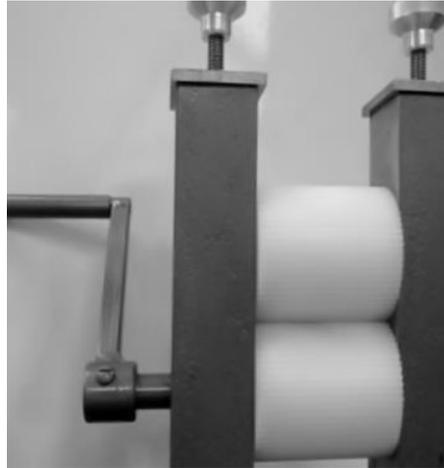
**Figura II.2.** Equipo utilizado como rizador de láminas.
