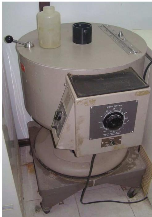
Figura 1.5 Equipo utilizado en la centrifugación para la obtención de muestras de agua intersticial
