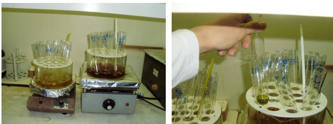
Figura 5: Fotografías de la mineralización de las muestras en baño térmico de glicerina. Fotos: Anabela Berazategui.
