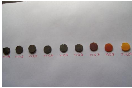
Figura 3.4. Los cilindros obtenidos se cortan a fin de obtener discos de 0,6 a 1,3 mm de espesor.
