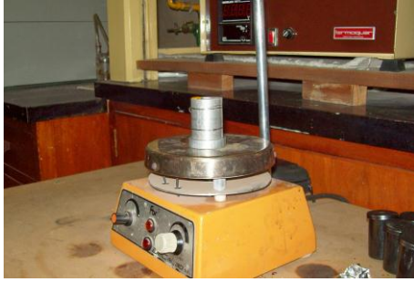
Figura 3.2. El cilindro de aluminio es precalentado sobre un plato calefactor.
