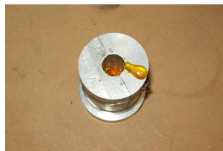
Figura 3.1. El fundido es volcado dentro de un cilindro de aluminio de 11 mm de diámetro.
