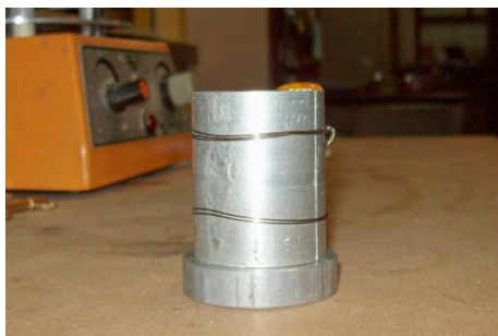
Figura 3.1. El fundido es volcado dentro de un cilindro de aluminio de 11 mm de diámetro.
