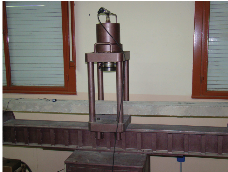
Figura 8.8: Modelo de una viga simplemente apoyada de hormigón armado
