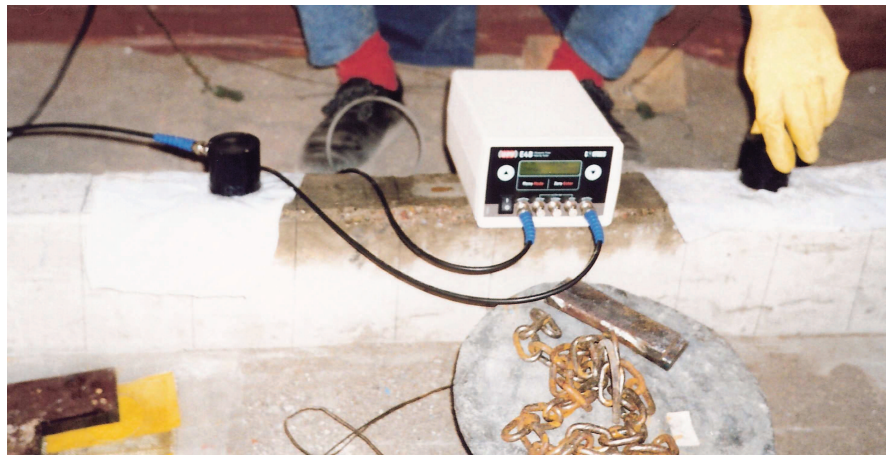
Figura 10.5: Medición de Ultrasonido
