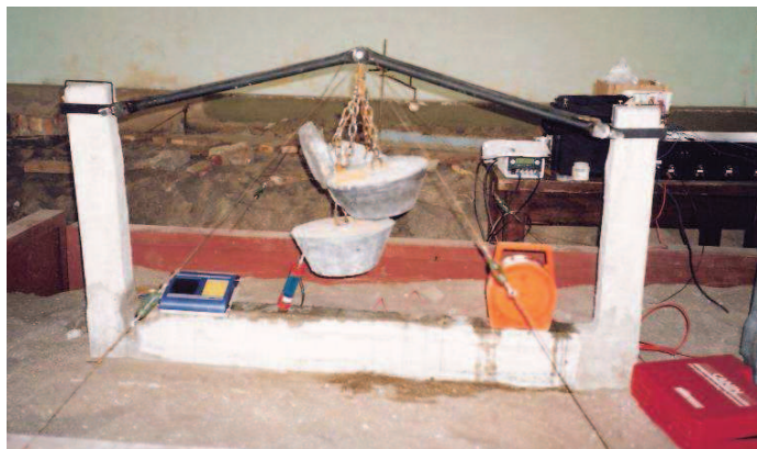
Figura 10.1: Fotografía de una viga de fundación durante el ensayo
