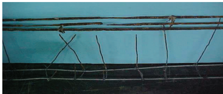
Figura 10.7: Disminución de sección de la armadura longitudinal y transversal
