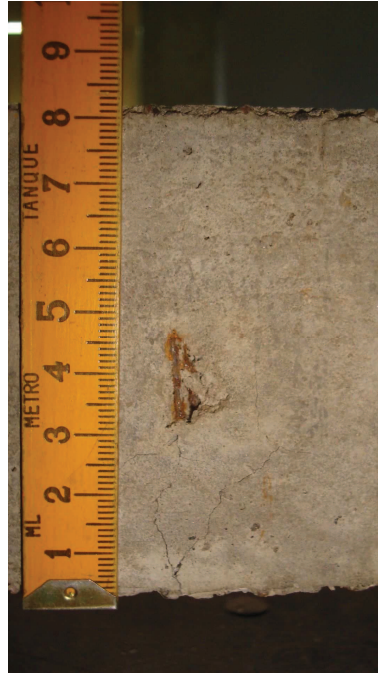
Figura 8.20: Modelo de viga ensayada en forma experimental con una fisura en el centro
