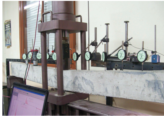
a) Vista General de la viga sobre el banco de ensayo
