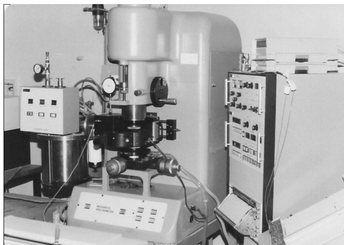
Figura A.2 - Vista general del reómetro RMS-605 en la que se observa el módulo de ensayos con cámara de termostatación (centro), módulo de control (derecha) y vaso Dewar con controlador de flujo (izquierda).
