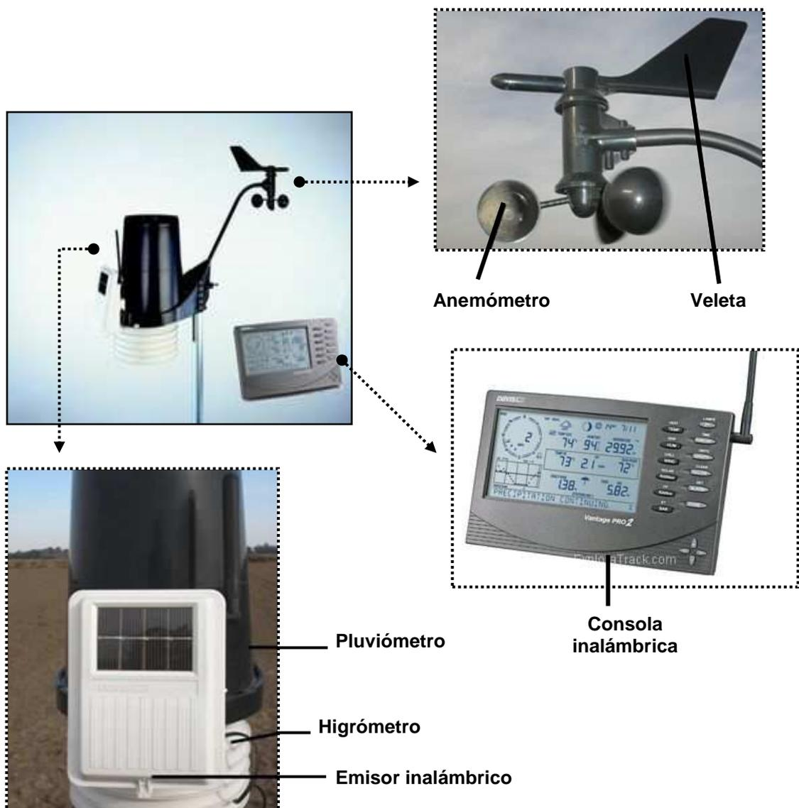
Figura 5. Vista de la estación meteorológica portátil y sus componentes.
