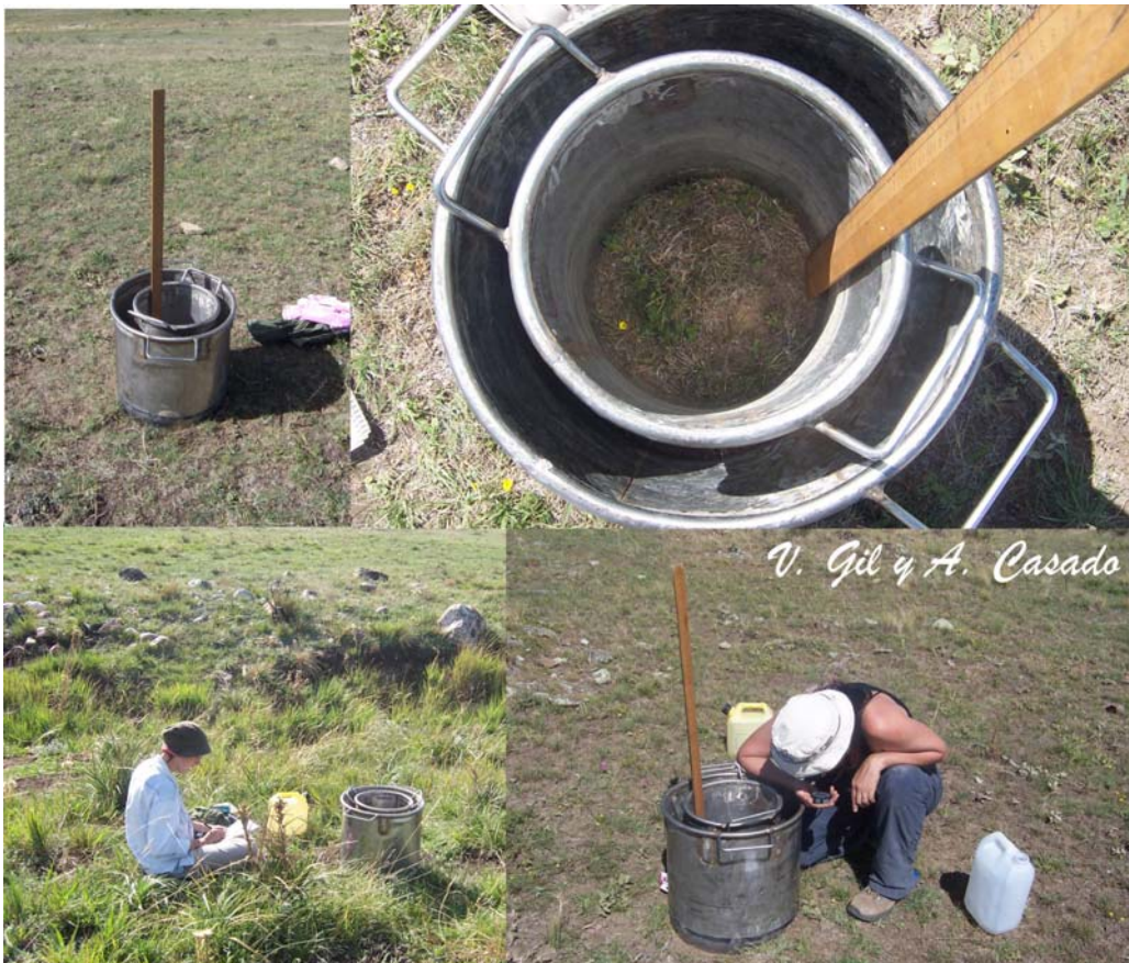
9.2. Ensayos de infiltración. Instrumento: infiltrómetro de doble anillo.
