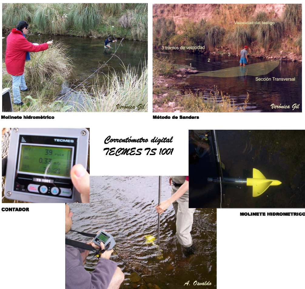
Figura 6.42. Aforos directos realizados en un tramo de la corriente. Detalle de instrumental para medición de caudal.
