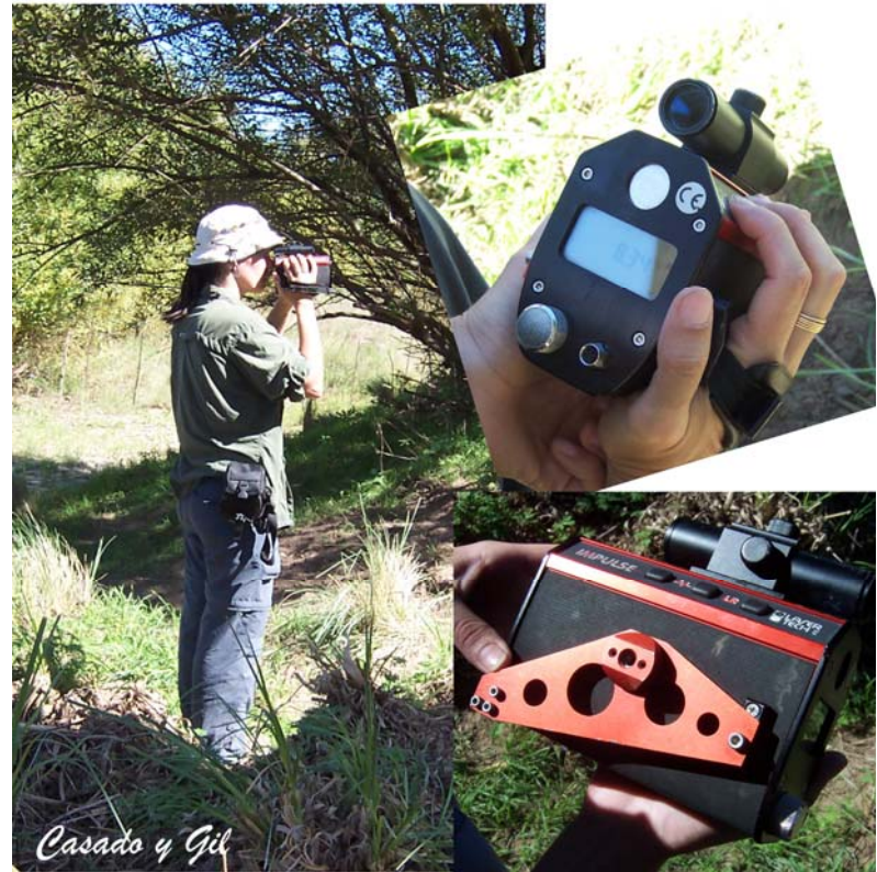
Figura 2.4. Nivel óptico digital utilizado para la obtención de perfiles
