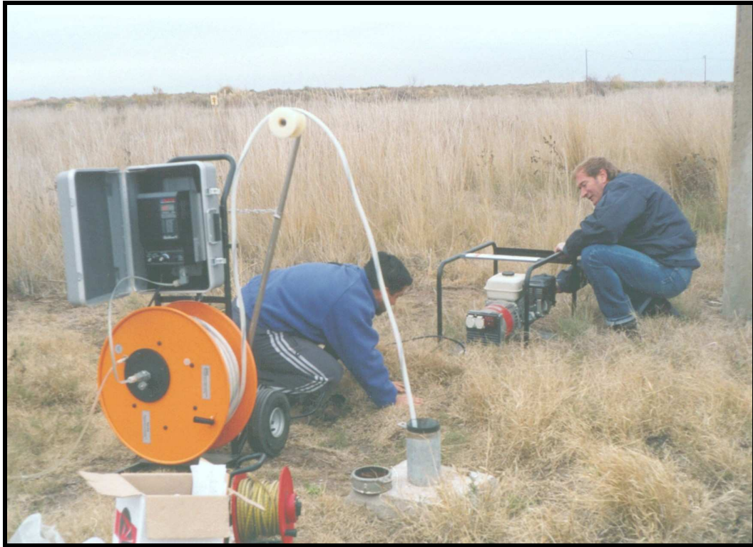
Foto 2.2.6.1.a. Muestreo de pozo profundo mediante electrobomba sumergible
