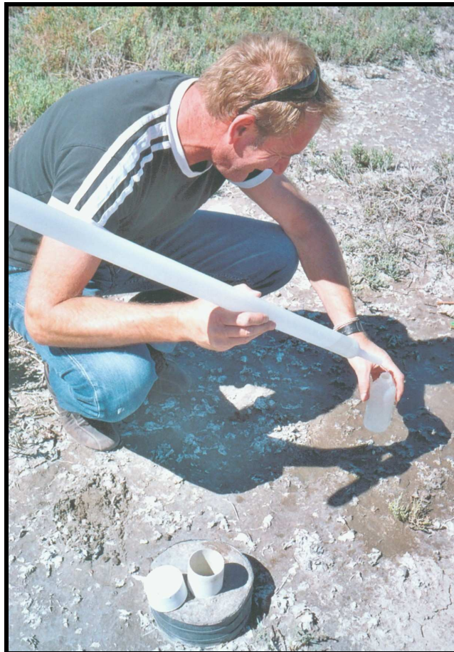
Foto 2.2.6.1.b. Muestreo de pozo somero mediante tubo bailer
