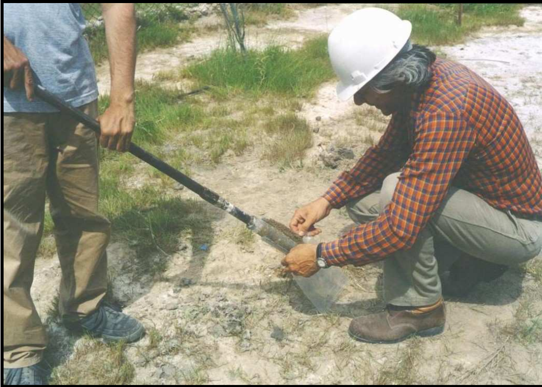
Foto 2.2.1.1.a. Muestreo de material de relleno y sedimentos en la parcela experimental por medio de la pala hélix
