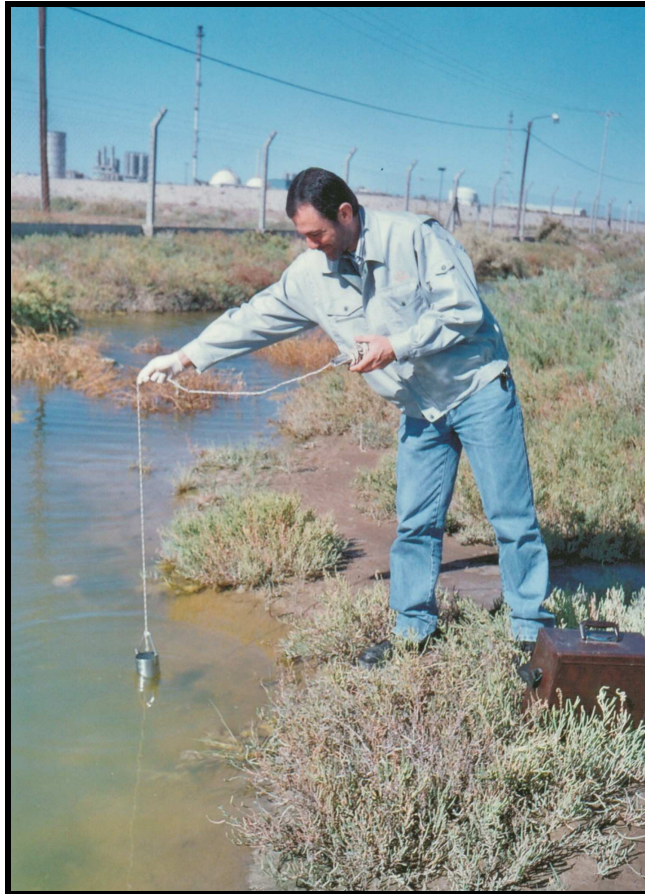
Foto 2.2.6.2. Muestreo de zanja de drenaje utilizando un recipiente de acero inoxidable
