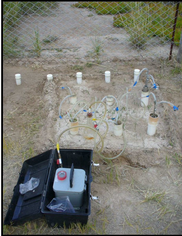
Foto 2.2.4. Muestro de agua intersticial a través de las cápsulas de succión
