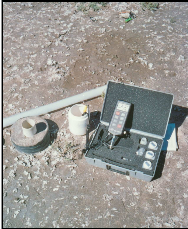
Foto 2.2.6.1.c. Determinación de parámetros in situ mediante pHímetro Cole Parmer
