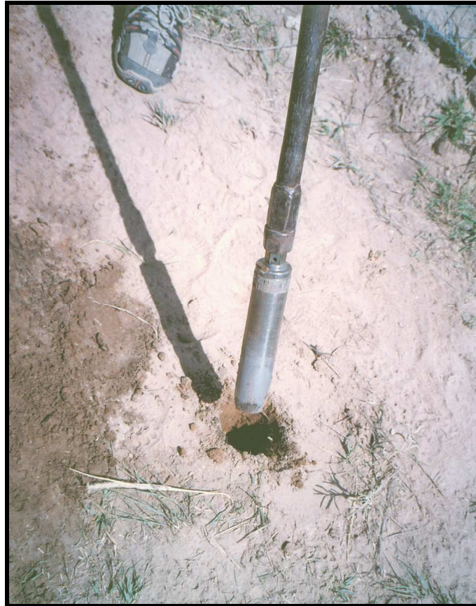
Foto 2.2.1.2.1. Muestreo de material inalterado en la parcela experimental por medio de tubo sacatestigo
