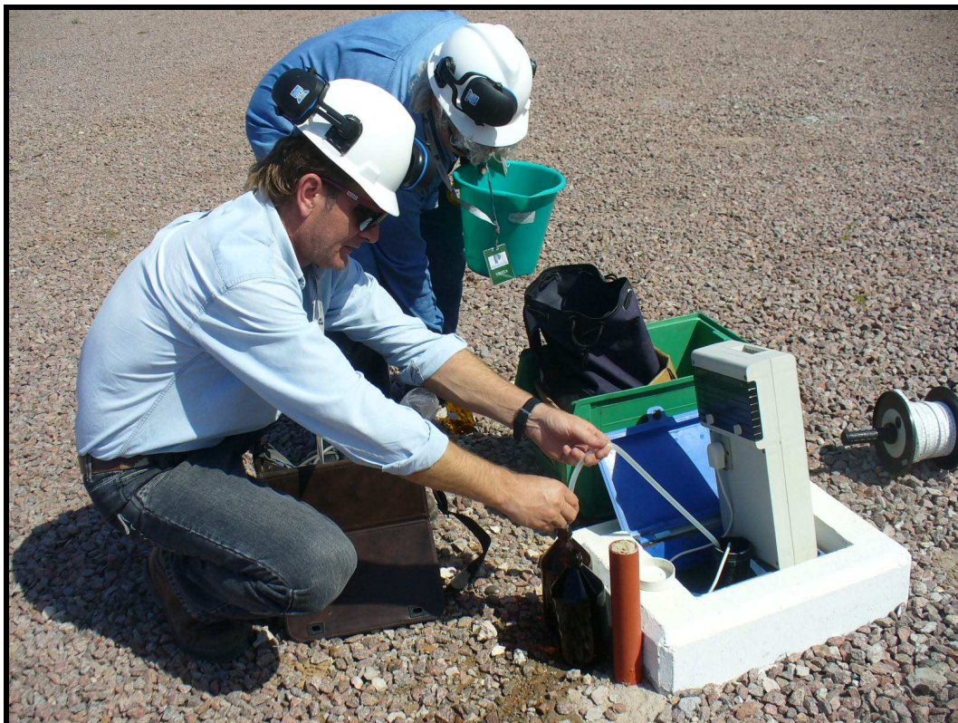
Foto 2.2.6.1.d. Muestreo de agua subterránea mediante bomba electrosumergible de pequeño caudal
