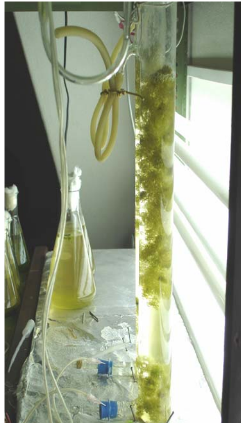
Fig. 42: esquema y foto de un fotobioreactor .
