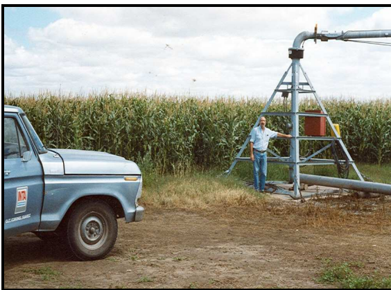
Equipo de riego. Pívo Central. Torre y comando de control.
